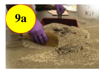
Masukkan serbuk gergaji/ pasir kedalam plastik dan berikan label/ identitas pada plastik terkontaminasi dengan serbuk gergaji/ pasir B3
