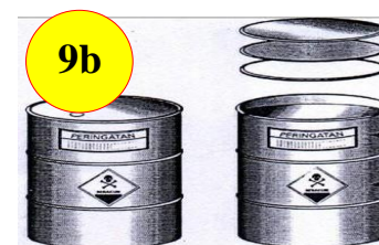
Tutup drum dan berikan label/ identitas pada drum tersebut dan leatakan di TPS B3
