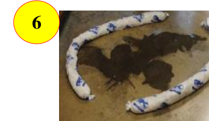
Isolasi tumpahan B3, agar tumpahan tidak menyebar ke area lain.
